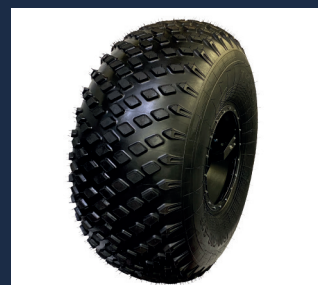
Шина 1600 x 700-635/ диск колесный 570-635
