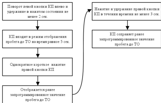
Блок-схема 5.1 Алгоритм сброса пробега до ТО.
