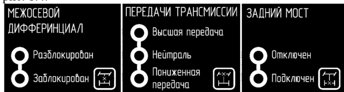
Рис. 6.4 Схема управления раздаточными коробками
