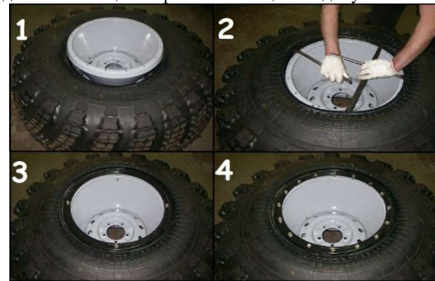
Рис. 10.4 Порядок монтажа шины ТРЭКОЛ
