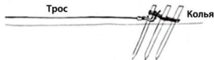
Рис. 20.9 Показывает пример правильного использования кольев. Это очень эффективный якорь, если почва позволяет им пользоваться. В землю их следует забивать под углом
