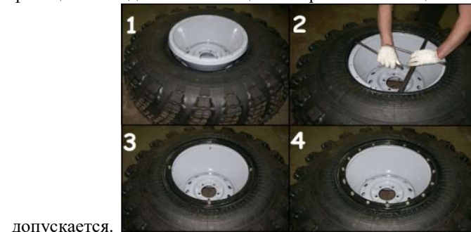
Рис. 10.4 Порядок монтажа шины ТРЭКОЛ
