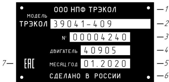
Рис. 4.2 Табличка заводских данных ВТС:
