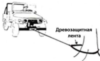
Рис. 20.3 Наиболее распространённый способ, обратите внимание, что в том случае, когда в качестве якоря используется ствол дерева, применяется древозащитная лента. Во избежание нанесения ущерба живой природе не пользуйтесь тросом или цепью. К тому же, трос нельзя обматывать петлей вокруг якоря, поскольку тем самым значительно уменьшается прочность троса на разрыв
