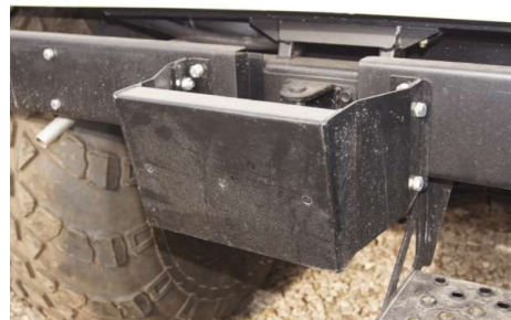
Рис.20.20 Транец для подвесного лодочного мотора
