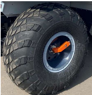
Рис. 20.27 Система централизованной подкачки колёс
