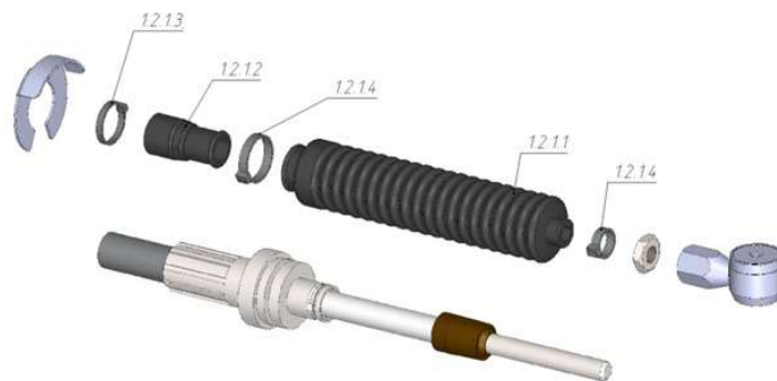
Рис. 6.8 Заменяемые части троса
