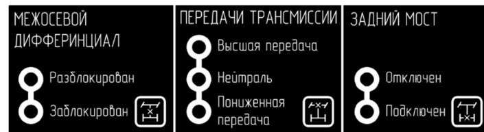
Рис. 6.12 Схема управления раздаточной коробкой и коробкой привода заднего ведущего моста без привода водомётного движителя
