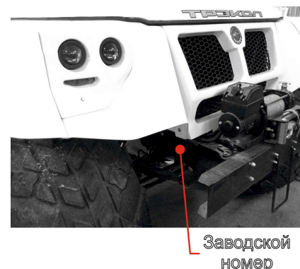
Рис. 4.3 Место обозначения заводского номера ВТС
