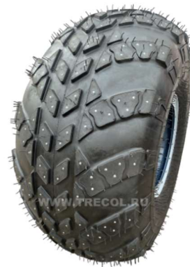
Рис. 20.57 Шина шипованная ТРЭКОЛ 1350х700-533
