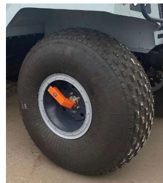
Рис.20.33 Система централизованной подкачки колёс
