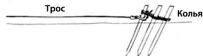
Рис. 20.11 Показывает пример правильного использования кольев. Это очень эффективный якорь, если почва позволяет им пользоваться. В землю их следует забивать под углом
