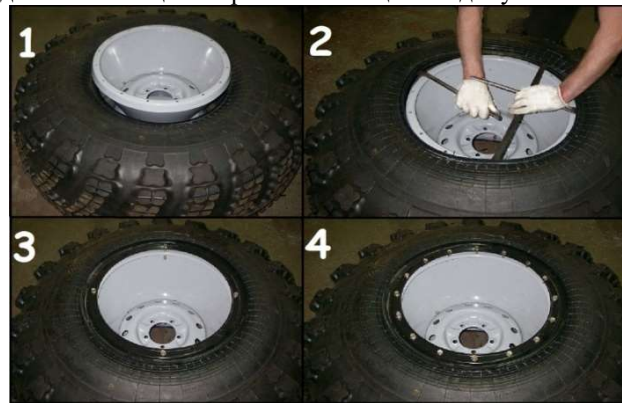
Рис. 10.4 Порядок монтажа шины ТРЭКОЛ
