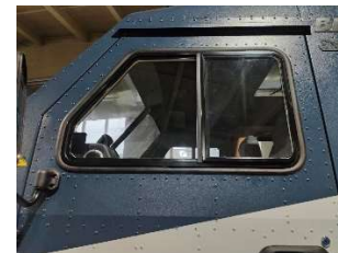
Сдвижные стеклопакеты передних дверей
