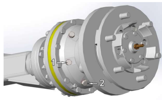
Рис. 9.6 Картер бортовой передачи: 1 - пробка заливного (контрольного) отверстия, 2 - пробка сливного отверстия.
